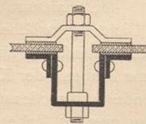
sind, während die Befestigung der Glastafeln durch Federn und Schraubenbolzen erfolgt, welche letzteren an einem, zwischen Holzaufleger und Rinneneisen durchgesteckten Flacheisen befestigt sind.
