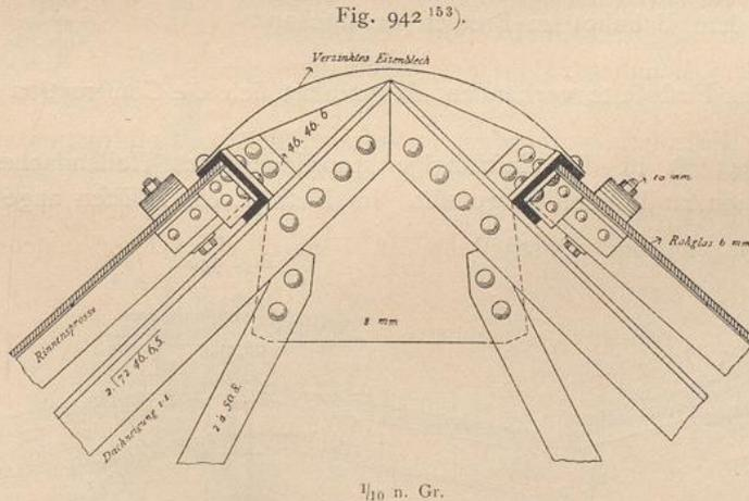
Diese Anordnung ist keine sehr günstige; die Dichtung zwischen Glas und  $\square$ -Eisen ist keine vollkommene. Die Pfetten liegen ziemlich weit aus einander; das Blech der Kappe trägt sich daher weit frei; die Breite derselben erleichtert das Begehen bei Dachausbesserungen u. f. w. und giebt daher zu Formveränderungen des Bleches Veranlassung. Die verschiedene Ausdehnung des den Sonnenstrahlen
