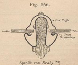
ständig durch eine Zinkumhüllung der tragenden Holzpfropfe gebildet. Bei der Construction von *Braby* (Fig. 866<sup>153</sup>) ruht die Glastafel auf einer geölten Hanfpackung; auch ist zur weiteren Dichtung und Befestigung eine Zinkkappe angeordnet, welche durch eine Schraube auf die Tafel gepresst werden kann.
