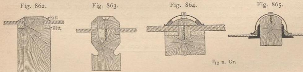
Holzleiste benutzt; auch sind zur Schweißwasser-Abführung in die Holzspresse feiliche Rinnen eingearbeitet. Eine ähnliche Dichtung zeigt Fig. 864. Man hat die Glastafeln auf Filzunterlagen gelegt, die Befestigung und Dichtung der Tafeln durch mittels Holzschrauben befestigte Holzleisten bewirkt, die letzteren durch Blechkappen gedeckt und nochmals zwischen Blech und Glas durch Theerstücke gedichtet.
