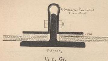
ι) Bei der in Fig. 878<sup>153)</sup> dargestellten Anordnung der Sproffen beim Bahnhof Duisburg sind die Glastafeln unmittelbar auf die **L**-Eisen gelagert; über die lothrechten Schenkel der **L**-Eisen sind Kappen aus verzinktem Eisenblech gelegt und mit Schrauben befestigt; zwischen den wagrechten Anfätzen dieser Kappen und den Glastafeln liegen Filzstreifen, welche die Dichtung bewirken sollen.
