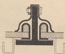
indess eine besondere Rippe hergestellt, welche an den Längsseiten der Tafeln herabläuft und durch Bleiblech, in welches ein Kittkörper eingeschlossen ist, gebildet wird. Außerdem ist eine aus Kupfer-, Blei- oder Zinkblech gebildete besondere Deckkappe, welche am lothrechten Schenkel des **L**-Eisens durch Schrauben befestigt ist, angeordnet. Nöthigenfalls können an die **L**-Eisen auch noch besondere Schweißwasserrinnen angehängt werden.
