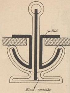
tungskappe ist mit der das Auflager bildenden Zinkblechumhüllung durch einen I-förmigen Bolzen aus Messing verbunden. An der Ueberdeckungsstelle der Glastafeln sind die Zinkspinnen gebogen, so dass der ganzen Tafellänge ein gleichmäßiges Auflager gewährt werden kann.
