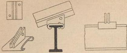
Auch hat man besondere Schuhe aus Schmiedeeisen, wie in Fig. 910 angedeutet ist, für die Auflagerung der Sproffen auf den Pfetten hergestellt. Für verwickeltere Sproffenformen kann man sich durch gusseiserne Schuhe helfen.
