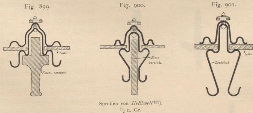
nommen. Beim *Helliwell*'schen System, »Perfection« genannt (Fig. 899 bis 901<sup>153)</sup>, ist ähnlich, wie bei dem vorhin erwähnten deutschen System, das Auflager der Glastafeln durch eine Zinkblechumhüllung und die Dichtung durch eine Zinkkappe gebildet, welche einen doppelten Anschluß an die Glasfläche gewährt<sup>170)</sup>. Die Dich-
