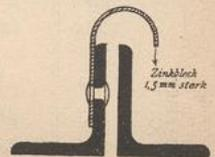
Der Zwischenraum zwischen den beiden Winkeleisen muss dann durch eine Kappe gedeckt werden, welche entweder nur an dem einen Winkeleisen befestigt ist oder durch ihre Form und Art der Befestigung eine gewisse Beweglichkeit gestattet (Fig. 871 u. 872<sup>168</sup>).
