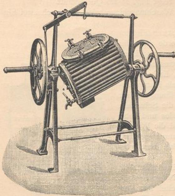
Einfache Trommel-Waschmaschine für Handbetrieb
