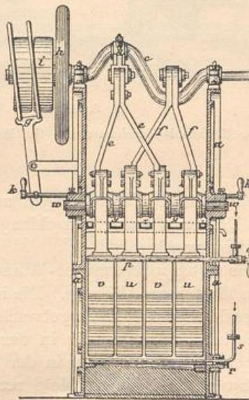
Eine Hammer-Waschmaschine besteht aus einem kupfernen Trog (Fig. 16 u. 17), worin 4 Hämmer, durch eine Kurbel bewegt, hin- und herschwingen. Die Wäsche wird in die Hohlräume *l* und *m* gelegt, von den Hämmern zu einem Knäuel geformt und beständig geknetet und gewendet. Im Trog befindet sich Waschlauge, die durch ein Dampfrohr *s* heiß gehalten wird.
