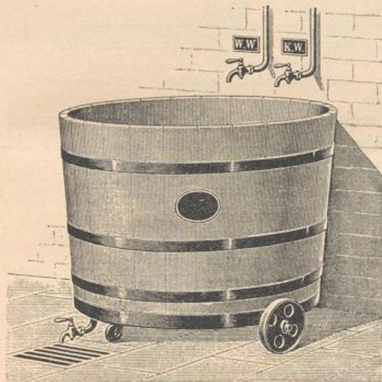
Fabrbarer Einweichbottich mit Kalt- und Warmwasserzuleitung<sup>11)</sup>. —  $\frac{1}{20}$  w. Gr.
