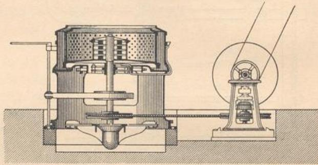
Zentrifuge mit motorischem Unterantrieb<sup>20)</sup>. $\frac{1}{25}$  w. Gr.
