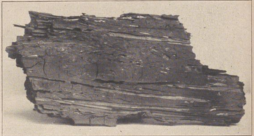
Abb. 8: Lehmshindelfstück nach dem Brande.
