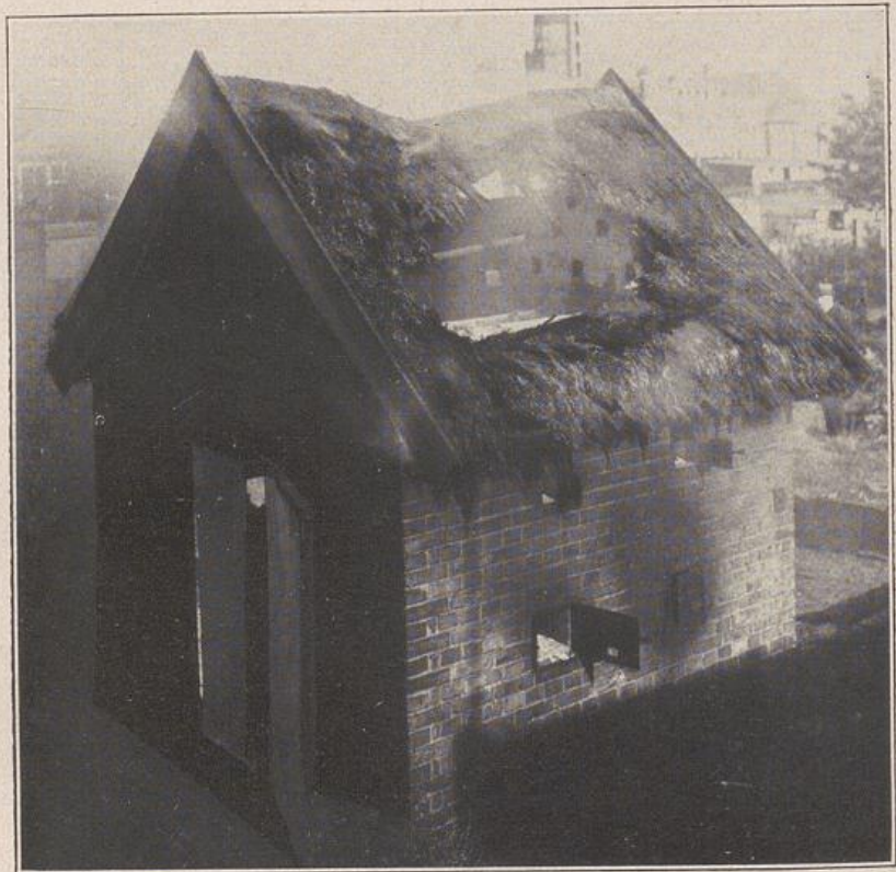
Abb. 5: Nach scharfem Innenfeuer ( +880^{\circ}\text{C} ) bricht das Dach ein, nachdem die Latten und Sparren durchgebrannt sind. Die Lehmshindeln haben dem Feuer widerstanden. Selbst die Firsteindeckung hat standgehalten, obgleich der Firstrahmen zum Teil verbrannt ist.
