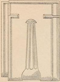
für diese Art von Falzziegeln ist die mittlere Erhöhung in conischer Form, welche mit ihrem breiten Ende die Fugendecken der unteren Steine schützt. Zwei Auffatzleisten auf der Oberfläche bezeichnen die Grenze der Ueberdeckung durch den oberen Ziegel. Ganz ähnliche Steine werden z. B. nach Fig. 342 von der Möncheberger Gewerkschaft zu Möncheberg bei Caffel, ferner von rheinischen, belgischen und holländischen Ziegeleien geliefert.
