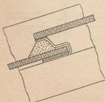
Bei der Halle des Nordbahnhofes zu Paris sind zwischen die aus Sproffeneisen gebildeten Hauptsproffen wagrechte Sproffen aus Zinklech in der in Fig. 928 angedeuteten Weise eingesetzt. Die oberen und unteren Enden der Tafeln sind kreisförmig abgeschnitten. Dem entsprechend sind auch die
