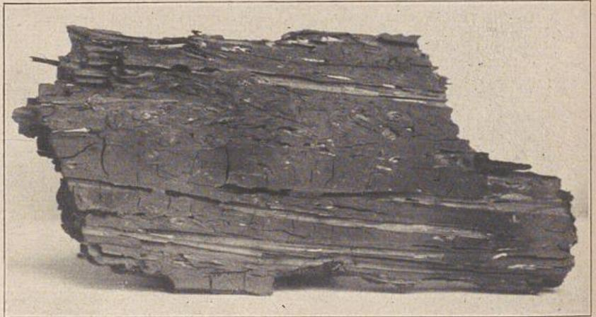
Abb. 8: Lehmschindelfstück nach dem Brande.
