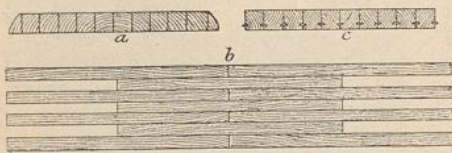
Holzplatten-Fußboden von Schultze 54 . 1/20 w. Gr.
