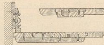
Befestigung des Fußbodens an eisernen Trägern (D. R.-P. Nr. 11 141 51) ).
