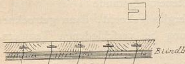
Fußboden mit Hammerstein'schen Stahlplättchen.
