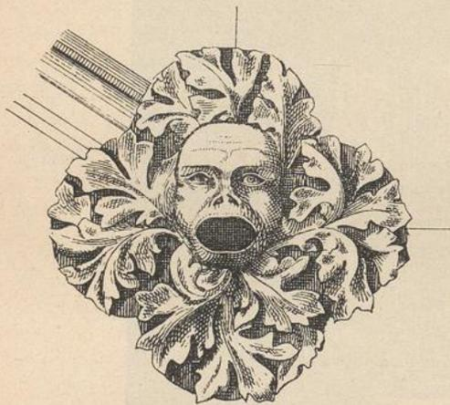
Kopf als Schlussstein mit Lüftungsöffnung<sup>181)</sup>.
