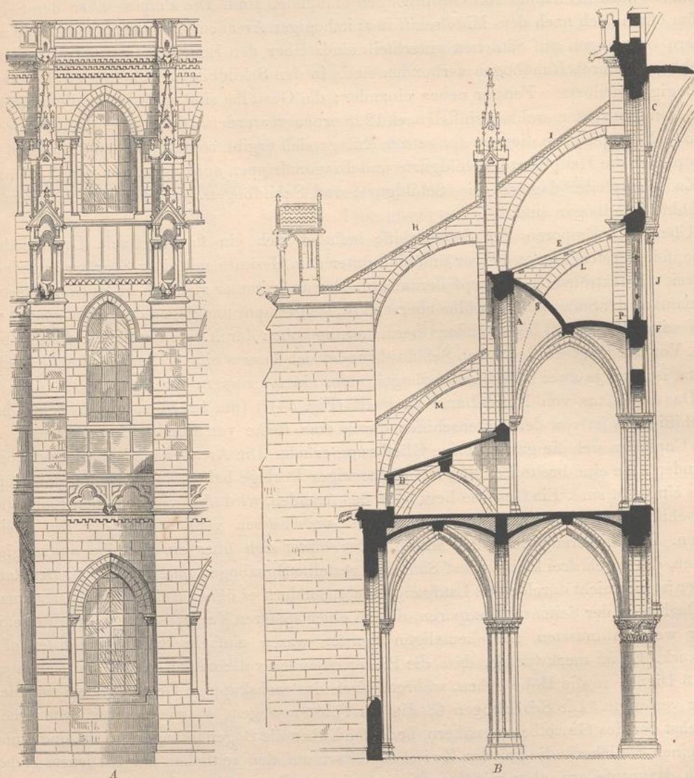
Fig. 54. Langhaus der Kathedrale Notre-Dame zu Paris. A Äussere Ansicht eines Joches. B Querdurchschnitt.
