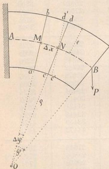
Denkt man sich durch die Längsachse des Balkens eine lotrechte Ebene gelegt, so schneidet diese die gebogene neutrale Faserschicht in einer krummen Linie, welche die elastische Linie genannt wird. Diese kann angesehen werden als zusammengesetzt aus einzelnen Kreisbögen, deren Halbmesser an verschiedenen Stellen des Balkens im allgemeinen verschieden groß sind.
