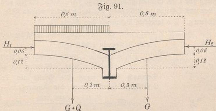
Nimmt man an, daß die Angriffspunkte der Lasten um 0,3 m von der Trägerachse entfernt sind, und daß die Horizontalschübe  $H_1$  und  $H_2$  der Gewölbe-fappen in der Mitte der Scheitelfuge angreifen (was streng genommen nicht ganz zutreffend ist), so erhält man:
