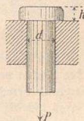
Aufgabe 52. Eine Blechtafel von  $\delta = 1,2 \text{ cm}$  Stärke soll mit Nietlöchern von  $d = 2,5 \text{ cm}$  Durchmesser versehen werden. Wie groß ist die zum Durchstoßen der Löcher erforderliche Kraft  $P$ , wenn man die Inanspruchnahme, bei welcher der Bruch erfolgt, = 4000 kg annimmt?
