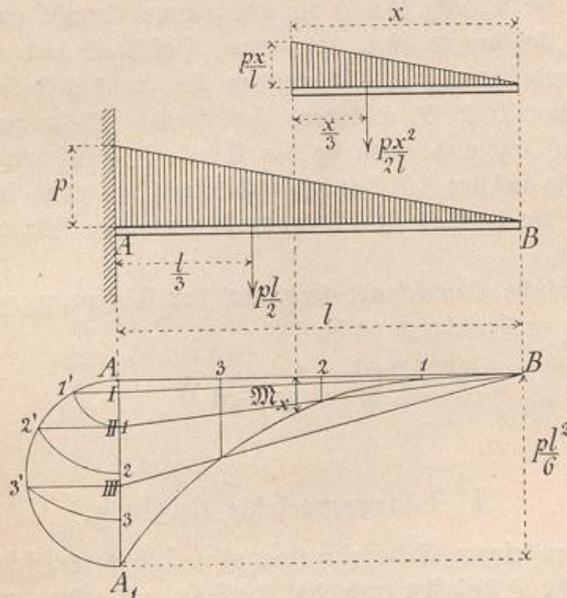
und nehme von dort aus stetig und gleichförmig ab bis auf Null am freien Ende B (Fig. 39). Die Belastungsfläche ist alsdann ein Dreieck.
