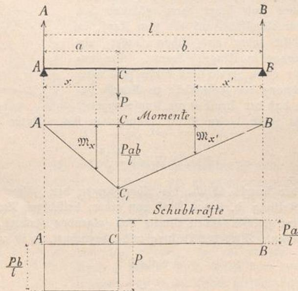
Ist der Träger  $AB$  (Fig. 46) durch eine lotrechte Kraft  $P$  belastet, welche die ganze Trägerlänge  $l$  in die Abschnitte  $a$  und  $b$  teilt, und werden die Stützenwiderstände mit  $A$  und  $B$  bezeichnet, so müssen sich die drei Kräfte  $ABP$  im Gleichgewichte halten, daher:
