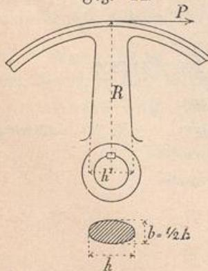
Auflösung. Die Arme können annähernd als fest in der Nabe eingespannte Träger von der Länge  $R$  betrachtet werden, die am anderen Ende durch die Kraft  $P$  belastet sind. Man kann (nach v. Bach) annehmen, daß  $1/3$  der Arme gleichzeitig und gleichmäßig zur Kraftübertragung beiträgt, so daß, wenn die Armzahl mit  $z$  bezeichnet wird, zu setzen ist:
