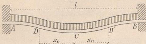
stützungspunkt den Auflagerdruck  $p x_0$  überträgt. Die Seitenstücke AD und BD' bilden daher gleichmäßig belastete Konsolträger, an deren freiem Ende die Einzelkraft  $p x_0$  wirkt.
