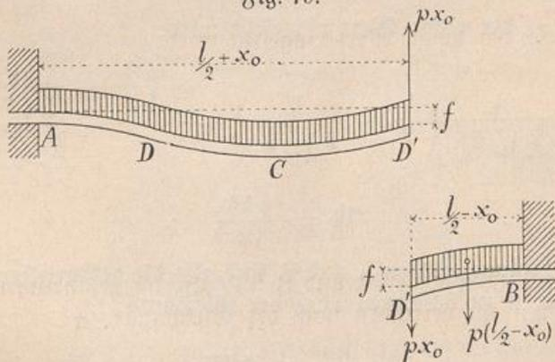
die lotrecht aufwärts gerichtete Kraft  $p x_0$ , für das rechte Trägerstück die lotrecht abwärts gerichtete Kraft  $p x_0$  als äußere Kraft hinzufügt (Fig. 79). Bezeichnet man die Durchbiegung des Punktes D' gegen die Punkte A und B mit  $f$ , so ergibt sich nach Gl. 36) S. 46 und Gl. 40) S. 49 für das linke Trägerstück:
