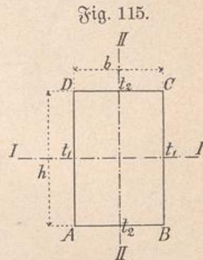
Aufgabe 72. Es sollen die Abmessungen  $h$  und  $b$  der in Fig. 116 abgebildeten, mit  $P = 4000 \text{ kg}$  belasteten Kurbel von rechteckigem Querschnitt berechnet werden, unter der Annahme, daß  $b = \frac{1}{2} h$  ist.
