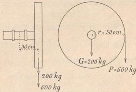
Auflösung. Für den durch die Mitte des Lagers gelegten Querschnitt ist das Biegemoment:
