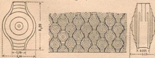
Glashohlsteine der Glashüttenwerke »Adlerhütten« in Penzig. 1/10 v. Gr.
