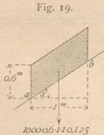
Die Last von 75 kg kommt auf  $\overline{ab}$  Quadrat-Meter der Dachfläche; da  $\overline{ab} = \frac{1}{\cos \alpha}$  ist, so kommt auf 1<sup>qm</sup> der schrägen Dachfläche eine Schneelast
