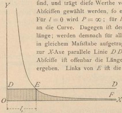
Wenn, wie gewöhnlich, die Last  $P$  und die Länge  $l$  gegeben sind, so handelt es sich um die Ermittlung von Form und Größe des Stabquerschnittes. Für diese Bestimmung
