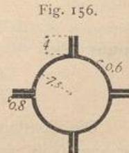
Am ungünstigsten ist demnach im vorliegenden Falle das I-Profil mit 83,9 kg Gewicht; günstiger ist das kreuzförmige Profil mit 59,2 kg, und am günstigsten ist das aus Quadranteifen zusammengesetzte, röhrenförmige Profil mit 42,9 kg Gewicht.
