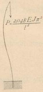
Durch entsprechende Endanordnung würde man also die Tragfähigkeit des Stabes verfehzhnfachen können. Die angegebenen Kräfte sind thatfächlich im Stande, den Stab zu zerknicken, und deshalb sind Sicherheits-Coefficienten einzuführen.
