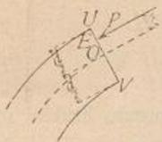
Der größte Druck  $\sigma_{max}$  findet für die in Fig. 387 gezeichnete Lage der Kraft  $P$  in den Punkten  $U$  statt, für welche  $z$  seinen größten Werth  $\frac{d}{2}$  hat; der kleinste Druck  $\sigma_{min}$  in den
