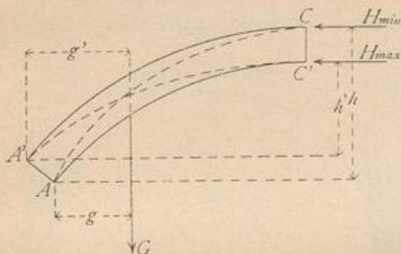
Bei flachen Bogen fallen die beiden Berührungspunkte mit der inneren Laibung in die Scheitelfuge, die Berührungspunkte mit der äußeren Laibung in die Kämpferfugen.
