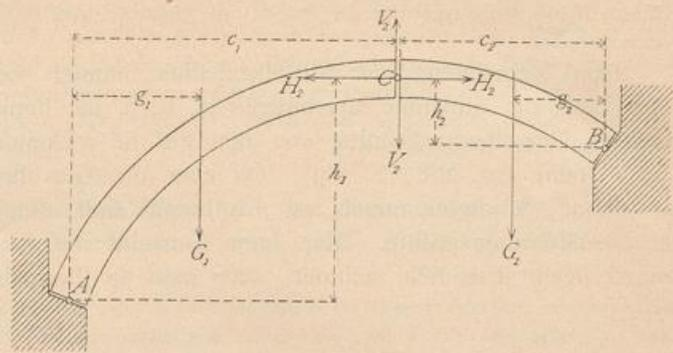
Die Mittelkräfte der Lasten auf dem linken, bzw. rechten Gewölbetheile seien  $G_1$ , bzw.  $G_2$ ; die Entfernungen dieser Lasten von den Kämpferpunkten seien bzw.  $g_1$  und  $g_2$  (Fig. 385). Die beiden Theile übertragen im Punkte  $C$  auf einander eine Kraft, deren Seitenkräfte bzw.  $V_2$  und  $H_2$  seien. Alsdann ergibt die Betrachtung der Gleichgewichtszustände beider Gewölbetheile die Gleichungen:
