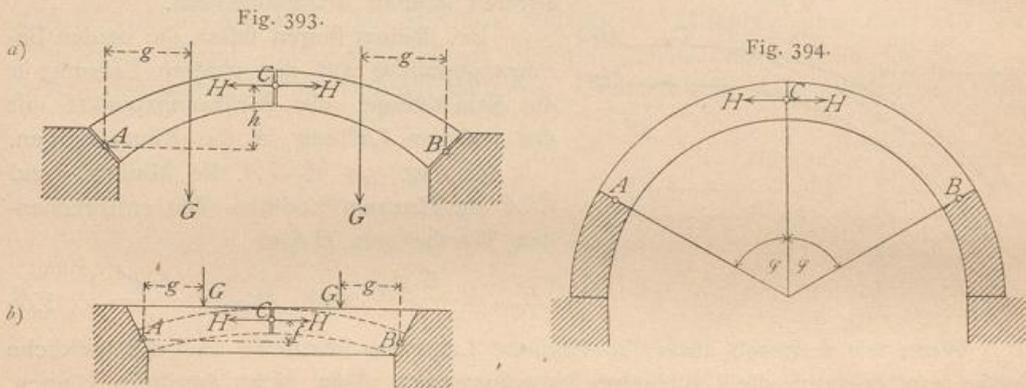
punkt auf der Lothrechten der Scheitelfuge liegt und dessen innere Laibung durch die unteren Punkte der Kämpferfugen, dessen äußere Laibung durch den obersten Punkt der Scheitelfuge geht. Dann wird nach Fig. 393 b)
