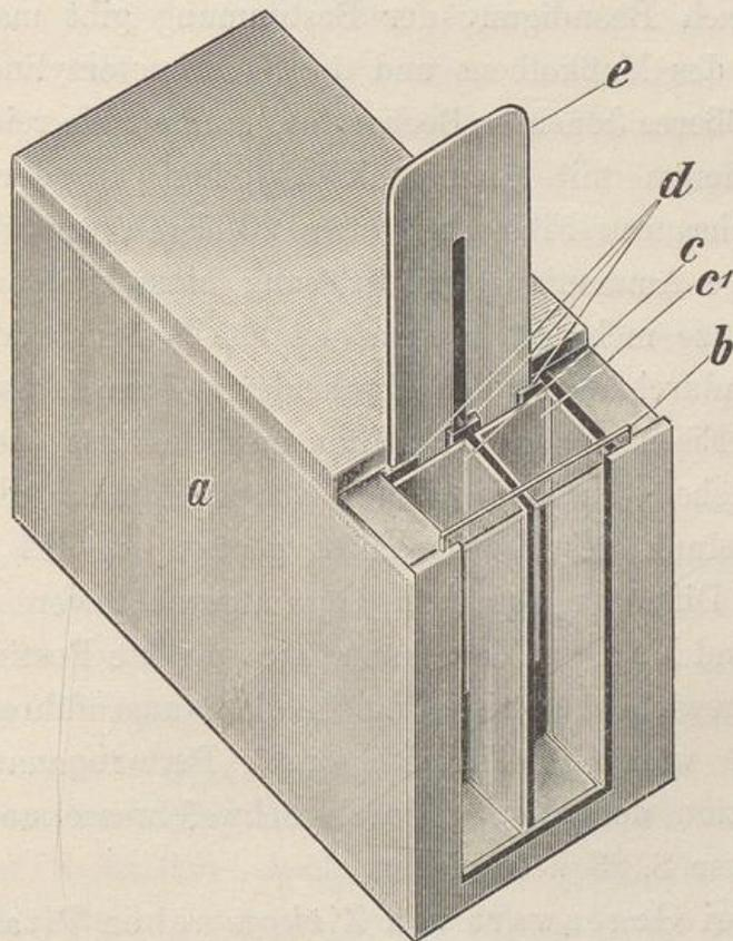
Fig. 1. Apparat zur kolorimetrischen Bestimmung der Titansäure.
