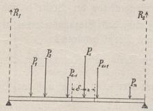
P<sub>k+1</sub>, ... P<sub>n</sub> belastet, welche am linken Auflager die Reaktion R<sub>1</sub> und am rechten Auflager die Reaktion R<sub>2</sub> hervorrusen. Für den Angriffspunkt von P<sub>k</sub> ist das linksseitige positive Biegungsmoment M ermittelt. Wie groß ist das linksseitige Biegungsmoment
