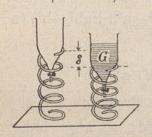
Gewichte G in das Gefäß geschüttet worden ist. Welche Arbeit (A) leistet die Feder, wenn man das Wasser tropfenweise aussließen läßt? Wie groß ist hiernach die Arbeitsfähigkeit oder Spannungsenergie der zusammengedrückten Feder? Anmerkung: Das Gewicht des Gefäßes und der Feder soll nicht berücksichtigt werden.
