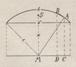
Von einem Kreisbogen sei der Radius r, die Bogenlänge b und die Sehnenlänge s bekannt. Wie weit (x) ist der Schwerspunkt S des Bogens vom Kreismittelpunkt M entfernt?
