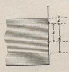
rechteckige Rlappe von der Höhe h, welche sich um eine horizontale Achse breben läßt, fo daß sie sich oben nach außen öffnet. Diefe Achse hat vom oberen Rand der Klappe die Entfernung z. Wie hoch (c) über ben oberen Rand ber Rlappe barf bas Waffer steigen, ehe die Klappe sich öffnet?
