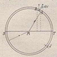
ftehendem Querschnitt und der Länge l wirke ein überall radial nach außen gerichteter Druck von der Druckstärke p. Wie groß ist die Zugkrast P, welche den Zylinder längs zwei diametral gegenüberliegenden, der Längsachse parallelen Schnitten S und T zu zerreißen sucht? Wie groß ist die hierdurch im Material hervorgerufene Zugspannung o?
