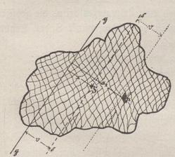
Eine Fläche F jei in fehr viele (n) fehr fleine Flächenteilchen  $f_1, f_2, f_3, \ldots, f_k, \ldots, f_n$ geteilt, deren fenfrechte Ent= fernungen von einer in der Ebene von F angenommenen Uchfeg mit a1, a2, a3, ....ak, .... an bezeichnet seien. Wie weit (x) ist der Schwerpunkt S der Fläche F von der Achje g entfernt?
