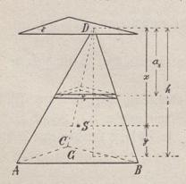
gelegt, und die Phramide durch weitere zu ABC parallele Ebenen in sehr viele (n) gleich hohe prismenartige Teilchen zerlegt. Wie groß  $(v_k)$  ist das  $k^{\text{te}}$  dieser Teilchen, wenn die Fläche ABC = G ist? Wie groß ist der Rauminhalt  $V = \Sigma v_k$  der Phramide? (Aufg. 24. b)
