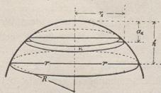
welche als Zylinder aufgefaßt werden können, geteilt. Wie groß  $(v_k)$  ist das  $k^{\text{te}}$  dieser Teilchen, wenn der Kugelradius R ist? Wie groß ist das Volumen V des Kugelabschnitts?
