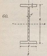
Wie groß ist  $J_x$  und  $J_y$  für ein I Profil von der Höhe h, der Breite b, der Stegdicke d und der Flanschdicke t?
