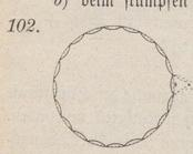
Bur Kannelierung dorischer Säulen bedient man sich eines dem Querschnittskreise eins geschriebenen Zwanzigecks, über dessen Seiten man nach innen Bögen zeichnet, deren Radius gleich der Seitenlänge ist. Wie groß ist der kannelierte Querschnitt, wenn die Seite des Zwanzigecks = s ist?
