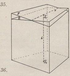
Die zur Grundfläche parallele Deckfläche F eines geraden Prismas (ober Zylinders) soll durch eine schiefe Deckfläche F<sub>1</sub> ersetzt werden, so daß das Bolumen des Prismas (oder Zylinders) unverändert bleibt. Welche Eigenschaft muß die Schnittlinie s von F und F<sub>1</sub> für beide Flächen besitzen?
