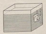
64. Gine vertifale Fläche F erfahre horizontalen Druck burch eine Flüssigkeit vom spezifischen Gewicht s. Wie groß ift der Druck pk auf ein Flächen= teilchen fk, beffen Entfernung vom Riveau ber Flüssigfeit ak ift? Wie groß ift ber refultierende Druck P für die ganze Fläche F? Wie groß ist P, wenn die hori= zontale Schwerlinie der Fläche F vom Flüssigkeitsniveau die Entfernung x hat?
