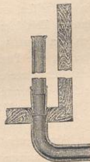
Standrohr- Ueberlaufventil für Badewannen.
