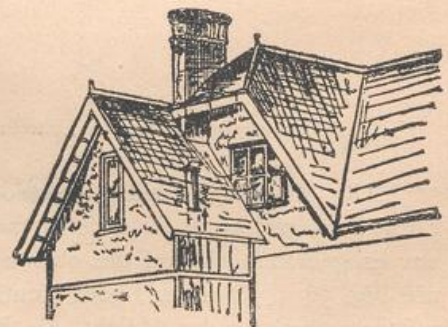
Fehlerhafte Anordnung der oberen Mündung des Luftrohres in der Nähe von Fenstern.
