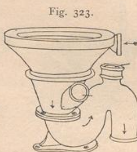
Trichter-Spülabort mit Lüftungsrohren II. und III. Ordnung.
