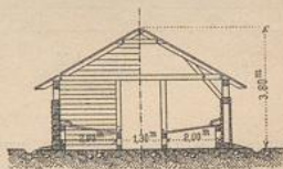
Blockwand- Baracke. Flechtwerk- Baracke.
