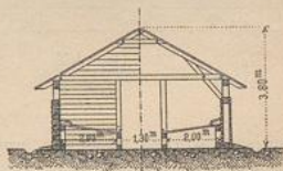
Blockwand- Flechtwerk- Baracke.
