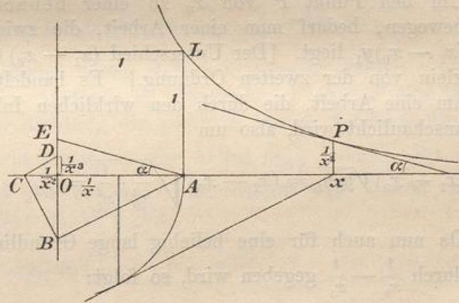
**Beispiel.** Für  $x = 1$  erhält man  $\tan \alpha = \frac{2}{1}$ . Die Neigung in  $L$  ist also leicht zu konstruieren. Man macht auf der  $X$ -Achse  $AV = +\frac{1}{2}$  und verbinde  $V$  mit  $L$ , was die Tangente giebt.
