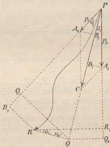
Die Addition der Arbeiten geschieht also einfach algebraisch ohne jede Berücksichtigung der Richtungen. Arbeitsgrößen gehören daher zu den Skalaren.
