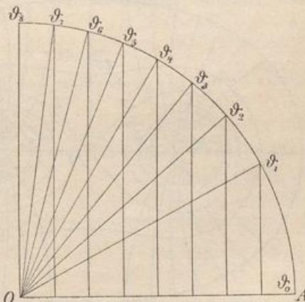
für die Winkel  $\vartheta_1$  und  $\vartheta_2$  auffassen, die durch Verbindung der Lotpunkte  $C_1$  und  $C_2$  mit  $O$  entstehen. Durch die festen Punkte  $M_1$  und  $M_2$  lege man Parallele zu  $OC_1$  und  $OC_2$ . Ihr Schnittpunkt giebt einen Punkt der Kurve
