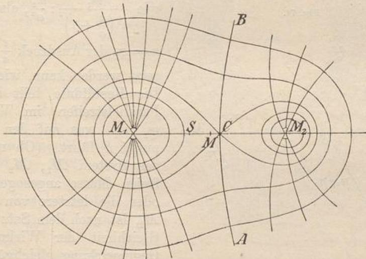
Durch Rotation um  $M_1M_2$  erhält man die Niveauflächen und Kraftflächen und durch Einführung von Meridianschnitten, die unter gleichen Winkeln aufeinander folgen, die potentiell gleichwertige Zelleinteilung des Raumes. In Fig. 72 ist das System skizziert.
