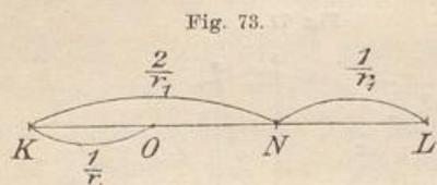
Ist  $KL = c$ , Fig. 73, die gewählte Konstante und  $N$  ein beliebiger Teilpunkt, so setzt man  $KN = \frac{2}{r_1}$ ,  $NL = \frac{1}{r_2}$ , bildet durch Halbierung  $KO = \frac{1}{r_1}$ , trägt  $KO$  und  $NL$  als  $MA_1$  bzw.  $MA_2$  in den Einheitskreis ein und verfährt wie vorher. Ebenso ist es bei den Kraftlinien.
