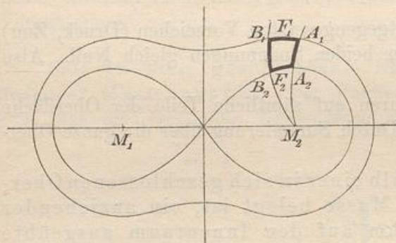
Führt man demnach in der gezeichneten Kraftrohre an verschiedenen Stellen Normalschnitte  $F_1, F_2, F_3, F_4, \dots$ , so ist, wenn  $p_1, p_2, p_3, p_4, \dots$  die entsprechenden Einheitsresultanten sind,  $p_1 F_1 = p_2 F_2 = p_3 F_3 = p_4 F_4, \dots$ , d. h. das Produkt aus der Einheitsresultante und dem Normalschnitt der Kraftrohre ist konstant.
