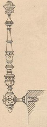
Geländerstab mit Krücke. 1/20 n. Gr.
