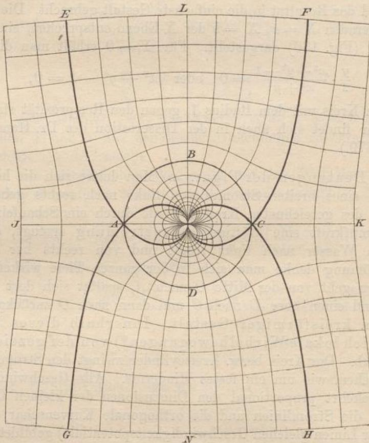
Später wird gezeigt werden, daß man sich rechts und links von  $O$  einen auf- und einen niedergehenden elektrischen Strom in Drähten denken kann, die normal zur Zeichnungsebene stehen. Die Kraftlinien der elektromagnetischen Wirkungen geben mit denen des homogenen, erdmagnetischen Feldes die vorliegende Zeichnung.
