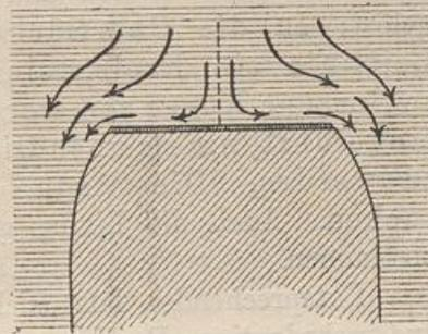
wird die Mittellinie des Strahles schräg, so daß er gegen die Wand anschlägt, was Störungen verursacht. Wird das Ausströmen durch eine in Fig. 149 dargestellte Platte gehemmt, so sind die dort gezeichneten die Grenzen der Ausströmung. Die abbildende Funktion ist
