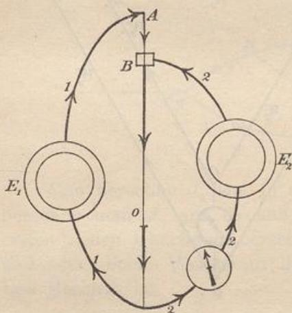
von bekanntem Widerstande  $a$ , auf dem der Kontakt  $B$  verschoben werden kann.  $E_1$  sei ein bekanntes,  $E_2$  ein zu messendes Element, wobei die Buchstaben zugleich die elektromotorische Kraft bedeuten. Nach Kirchhoff ist für den Punkt  $B$
