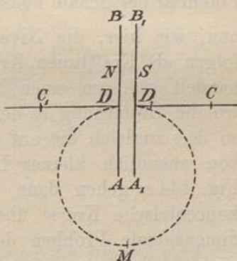
man auch die magnetische Einheit — ohne durch das Blatt selbst zu gehen — von  $D_1$  nach  $D$  führe, stets ist die Arbeit  $4w\delta\pi$  nötig.
