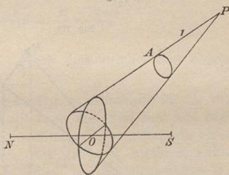
Der Potentialwert eines Elementarmagnets in einem beliebigen Punkte  $P$  ist gleich dem räumlichen Winkel, unter dem man von dort aus eine kreisförmige Hilfsfläche erblickt, die mit der Äquatorebene des Magnets zusammenfällt und deren Inhalt durch den Wert des magnetischen Moments dargestellt wird.
