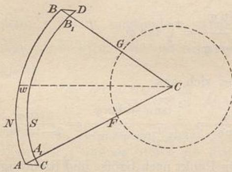
In Fig. 172 ist  $AB$  die mit Nordmagnetismus,  $A_1B_1$  die mit Südmagnetismus belegte Fläche.
