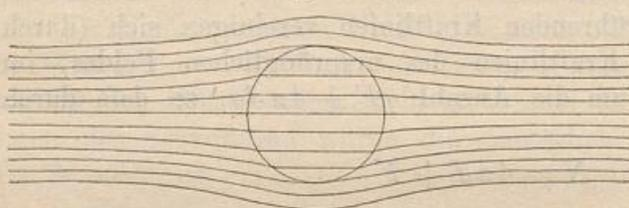
dieser außerordentlichen Durchlafsähigkeit erklärt sich die Schirmwirkung des Eisens ganz von selbst. Man versteht, wie nach Fig. 181 bei einem Hohlzylinder von weichem Eisen von den äusseren Kraftlinien kaum eine durch den inneren Hohlraum geht.
