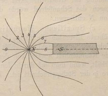
des Eisens denke man sich einen Kanal, in dem die Strömung z. B. durch ein Schaufelrad mechanisch unterstützt wird. Dadurch wird mehr Wasser in den Kanal eingesaugt, als ohne diese Unterstützung, die Stromlinien also werden so abgelenkt, daß sie sich nach *S* hin zusammendrängen, wodurch zugleich die Geschwindigkeit verstärkt wird. Ist nun das Rad an den Kanalwänden befestigt, so will die Reaktion diese Wände in entgegengesetzter Richtung vorwärts treiben, wie es beim Dampfschiffe geschieht.
