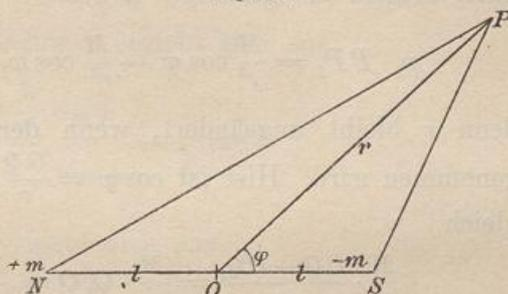
Gegenkraft  $\frac{m}{r^2}$  ist nur die Horizontalkomponente  $\frac{m}{r^2} \cos \varphi$  zu überwinden. Da der Arbeitsweg gleich  $2l$  ist, handelt es sich um die Arbeit  $\frac{m}{r^2} \cos \varphi 2l$ . Hier ist  $2ml$  das magnetische Moment  $M$  des Stabes, also ist der gesuchte Potentialwert angenähert gleich  $V = \frac{M \cos \varphi}{r^2}$ .
