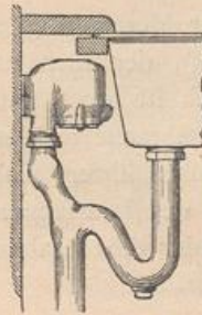
Spülausgufs mit S-Verschluß und McClelland-Ansatzventil.
