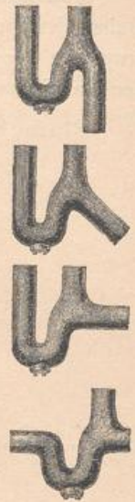
Bleierne Wasserverschlüsse mit Ansatzstutzen für Lüftungsrohre.
