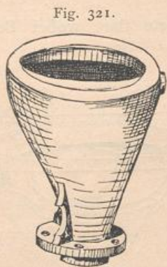
Hopper-closet von Rhoads mit Porzellanfitz.
