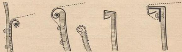
aufgerollte Rinnenrand wird bei Zinkrinnen durch eingelegten Draht versteift. Anstatt nach innen kann der Rinnenrand in derselben Weise nach aussen aufgerollt und durch einen aussen angenieteten Eisenblechstreifen gehalten werden (Fig. 676). Der Blechstreifen lässt sich im letzten Falle zugleich zur Verankerung des äusseren Rinnen-
