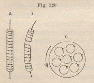
elektrischen Strome. Man denke sich in unbegrenzter Wassermasse einen geraden oder gekrümmten Cylinder, in dem sich eine große Anzahl wirbelnder Elementarcylinder befinden. (Fig. 220.) Fig. c stellt den Querschnitt eines solchen Komplexes dar, durch den man an die Ampèresche Darstellung magnetischer Molekularströme erinnert wird, die durch einen Solenoidstrom ersetzt werden können. Es wird sich zeigen, daß, wenn alle Elementarcylinder
