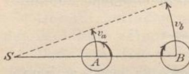
c) Drehen die Wirbel entgegengesetzt, so ist es ähnlich, wie bei entgegengesetzten Kräften (bzw. Massen).
