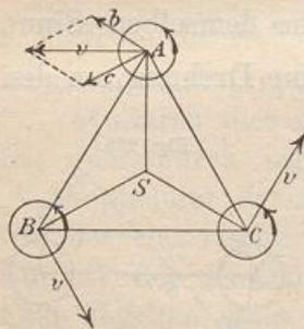
e) Es handle sich um drei gleichwertige Wirbelfäden, die in der Zeichnung ein gleichseitiges Dreieck bilden. Jeder erhält zwei gleiche Geschwindigkeiten senkrecht gegen die entsprechenden Dreiecksseiten, deren Resultante senkrecht zur Mittellinie steht. So entsteht Drehbewegung um den Mittelpunkt  $S$  des Dreiecks ohne sonstige Änderungen.
