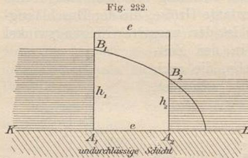
Es handelt sich also um diejenige Parabel, deren Achse in die Grenzlinie  $KL$  der undurchlässigen Schicht fällt, und die durch die Niveaupunkte  $B_1$  und  $B_2$  geht. Der Scheitel  $S$  ist
