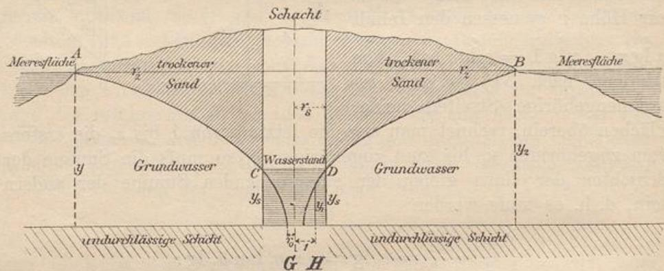
Die Zeichnung stellt den Vorgang schematisch dar.  $AB = 2r_2$  ist der Durchmesser der Insel und zugleich die Linie des ursprünglichen Grundwasserstandes.  $HDB$  ist eine der durch Gleichung 4) dargestellten Kurven.
