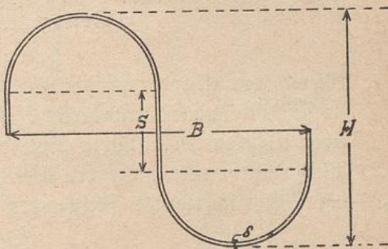
dessen Wellenbreite  $B = 90 \text{ mm}$ , dessen Wellenhöhe  $H = 70 \text{ mm}$  und dessen Stärke  $\delta = 1 \text{ mm}$  ist? Wieviel (G) wiegt 1 qm dieses Wellblechs, wenn das spezifische Gewicht  $s = 7,6 \text{ kg pro cdm}$  ist?
