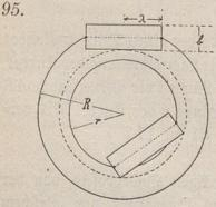
Ein Rechteck von der Länge  $l=2\lambda$  ist mit den Mittelpunkten seiner kürzeren Seiten beweglich auf einem Kreise vom Radius R angeordnet. Ein kongruentes Rechteck ist ebenso auf einem konzentrischen Kreise vom Radius r angeordnet. Wie breit (b) darf jedes Rechteck sein, wenn sich dieselben bei der Bewegung gerade berühren sollen?
