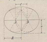
als Radius Kreise und um deren Schnittspunkte Kreisbögen mit dem doppelten Radius dis zur Berührung mit den ersten Kreisen, so entsteht eine ellipsensähnliche Figur. Wie groß sind die Halbachsen R und r, der Umfang U und der Inhalt F dieser Figur? Um wieviel (d) ist F größer, als der Inhalt
