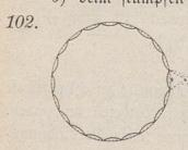
Zur Kannelierung dorischer Säulen bedient man sich eines dem Querschnittskreise eins geschriebenen Zwanzigecks, über dessen Seiten man nach innen Bögen zeichnet, deren Radius gleich der Seitenlänge ist. Wie groß ist der kannelierte Querschnitt, wenn die Seite des Zwanzigecks = s ist?
