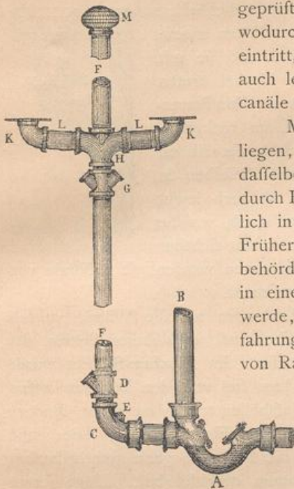
Frei tragende Röhre des Durham -Systems.
