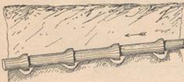
Verlegen von Thonrohren in der Grabenfohle.
