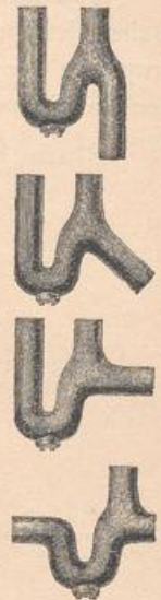
Bleierne Wasserverschlüsse mit Ansatzstutzen für Lüftungsrohre.
