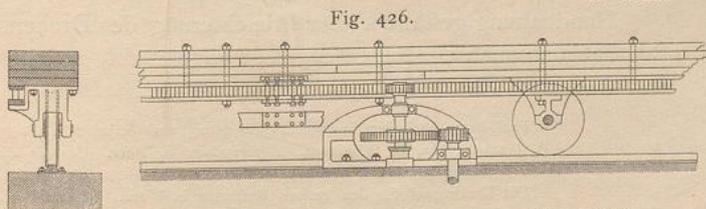
Gleit- und Triebwerk von der Sternwarte zu Zürich<sup>389</sup>.
