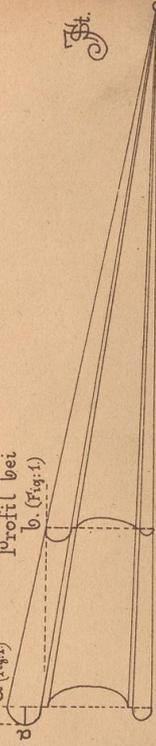
Abmessungen für das Profil der Schnecke.
