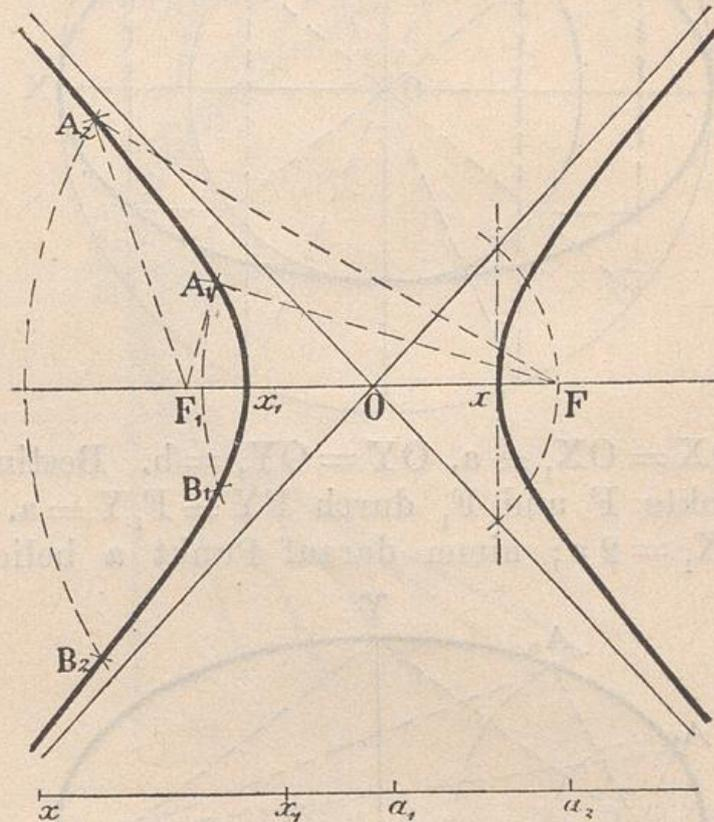
und um  $F_1$  mit  $x_1 a_1$  Bögen, die sich in  $A_1$  und  $B_1$  schneiden.  $A_1$  und  $B_1$  sind Punkte der Hyperbel. Verfahre ebenso mit  $a_2$  u. s. f.
