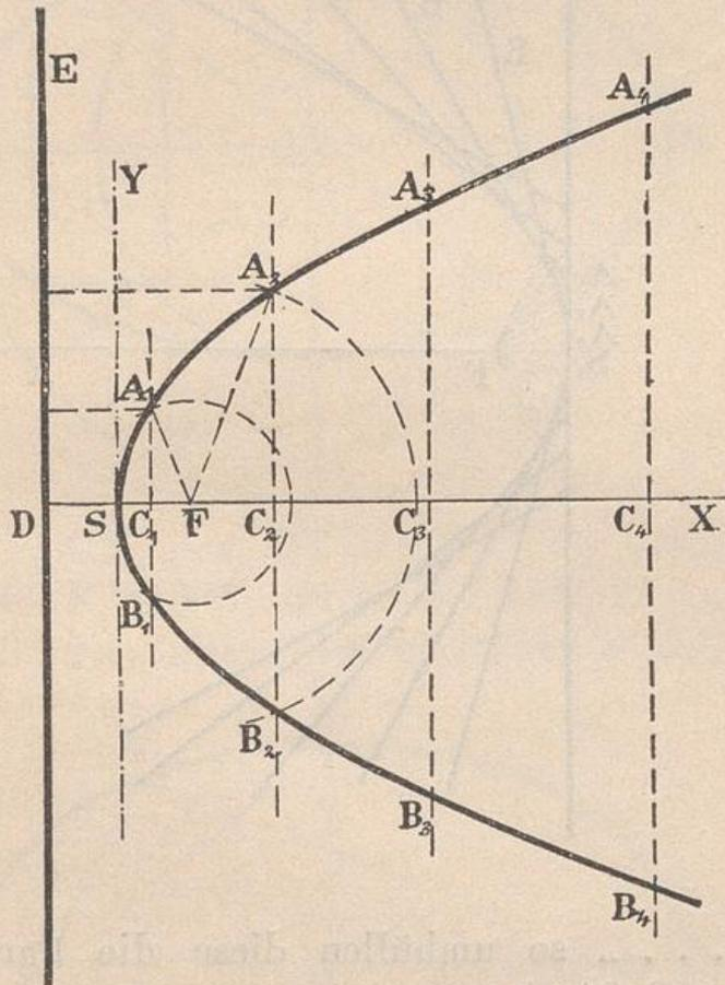
fahre ebenso mit  $DC_2$  u. s. w.  $A_1, A_2, A_3 \dots$ ,  $B_1, B_2, B_3 \dots$  sind Parabelpunkte. (Begründung: Jeder Punkt der Parabel hat vom Brennpunkt und der Leitlinie gleiche Abstände.)
