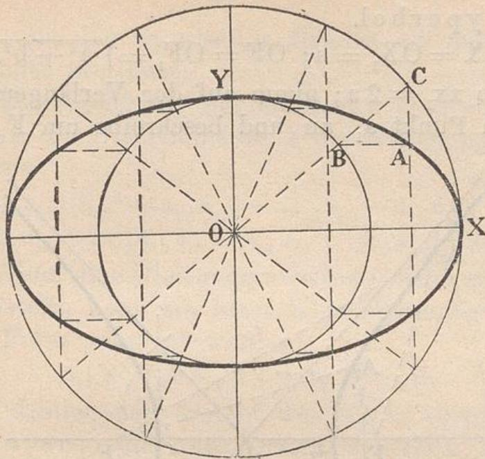
b.  $OX = OX_1 = a$ ,  $OY = OY_1 = b$ . Bestimme die Brennpunkte  $F$  und  $F_1$  durch  $FY = F_1Y = a$ . Ziehe  $xx_1 = XX_1 = 2a$ ; nimm darauf Punkt  $a$  beliebig an,
